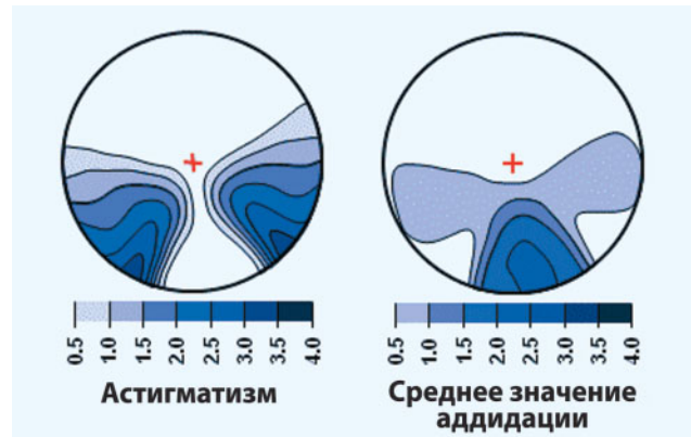
Рис. 4. Контурные карты с изолиниями, соединяющими точки с одинаковой оптической силой, показывают, как изменяется качество оптики по поверхности линзы.
