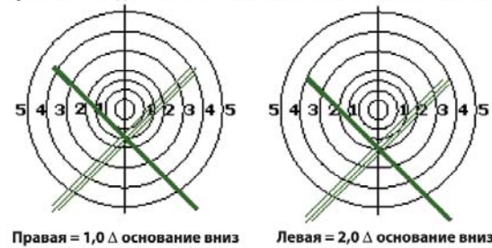
Рис.12. Измерение разницы вертикальных призм в случае назначенной для левого глаза призмы 1,0 \Delta
