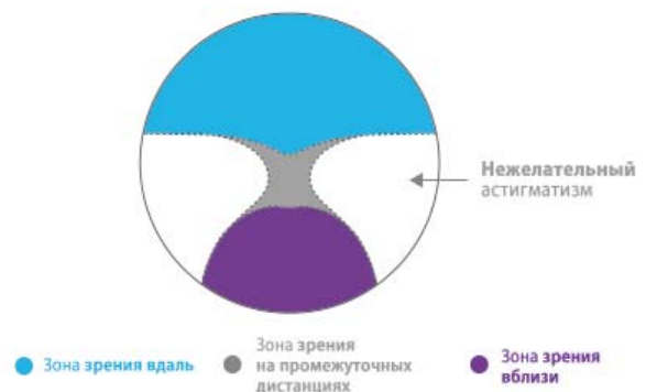
Рис.1. Оптические зоны прогрессивной линзы
