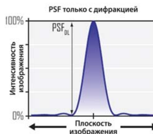
Рис.6. Функция рассеяния точки для оптической системы с одной только дифракцией (слева) и системы со значительными aberrациями
