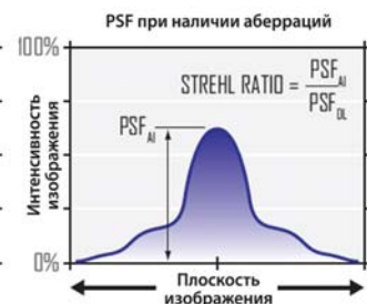
Рис.6. Функция рассеяния точки для оптической системы с одной только дифракцией (слева) и системы со значительными aberrациями
