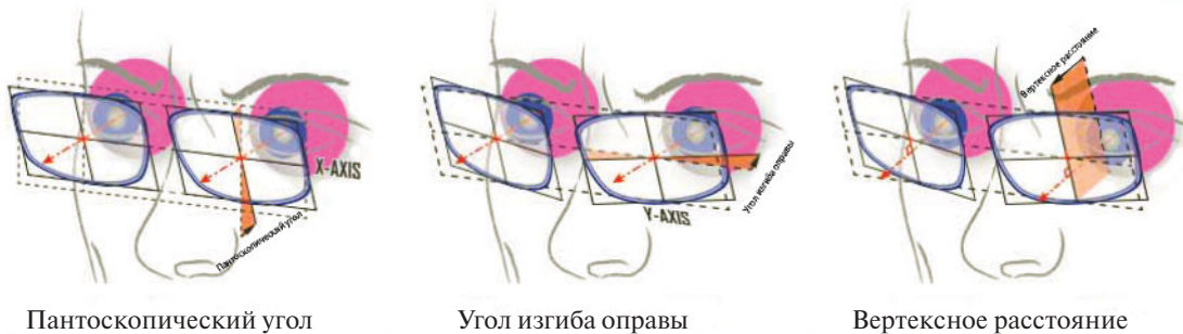
Рис. 4. Ориентация апертуры линзы определяется пантоскопическим (вертикальным) углом наклона передней плоскости оправы вокруг горизонтальной оси X и горизонтальным наклоном светового проема относительно передней плоскости оправы вокруг вертикальной оси Y (углом изгиба оправы). Заднее вертексное расстояние определяется как расстояние вдоль линии взгляда от вершины роговицы до задней поверхности линзы, когда линия взгляда перпендикулярна передней плоскости оправы или при взгляде прямо вперед.
