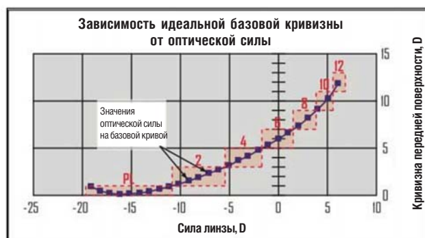
Рис.1. Каждая оптическая сила линзы требует своей базовой кривизны (кривизны передней поверхности) или асферического дизайна для устранения aberrаций. Однако обычно все значения оптической силы линз сгруппированы в ограниченный набор базовых кривых (точки на кривой), чтобы уменьшить стоимость готовых линз.
