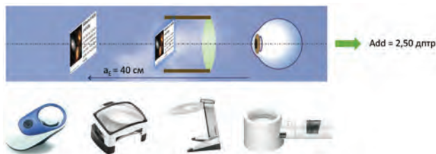
Рис.20. Определение аддидации при использовании настольных луп на рекомендуемом расстоянии (Изображение объекта (в синей рамке) сформировано на расстоянии 40 см). (Изображения луп взяты с сайта http://www.eschenbach-sehhilfen.com )
