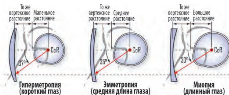
Рис. 24. Поскольку осевая длина глазного яблока зависит от рефракции глаза, то расстояние от роговицы до центра вращения глаза (CoR) также зависит от рефракции. Это приводит к тому, что угол наклона линии взгляда, пересекающей линзу на одинаковом расстоянии от точки центрирования линзы (по вертикали), также будет изменяться, и это изменение необходимо учитывать при расчете наилучшего прогрессивного дизайна.
