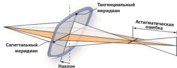
Рис.11. Наклон оптической оси очковой линзы относительно заданной плоскости изображения индуцирует астигматизм наклонных пучков из-за наклонного падения световых лучей на линзу. В результате увеличивается оптическая сила по тангенциальному и по сагиттальному меридиану. Однако тангенциальное увеличение больше, чем сагиттальное. Поэтому у сферической линзы возникает цилиндрическая составляющая оптической силы.
